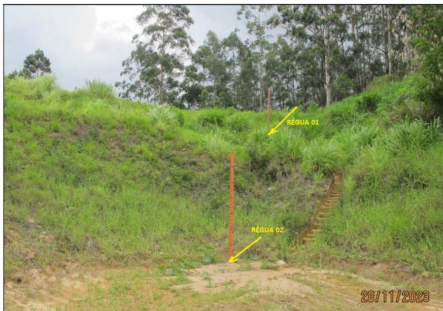
Figura 6.6- Régua linimétrica para a medição dos níveis de assoreamento e da lâmina d'água.
