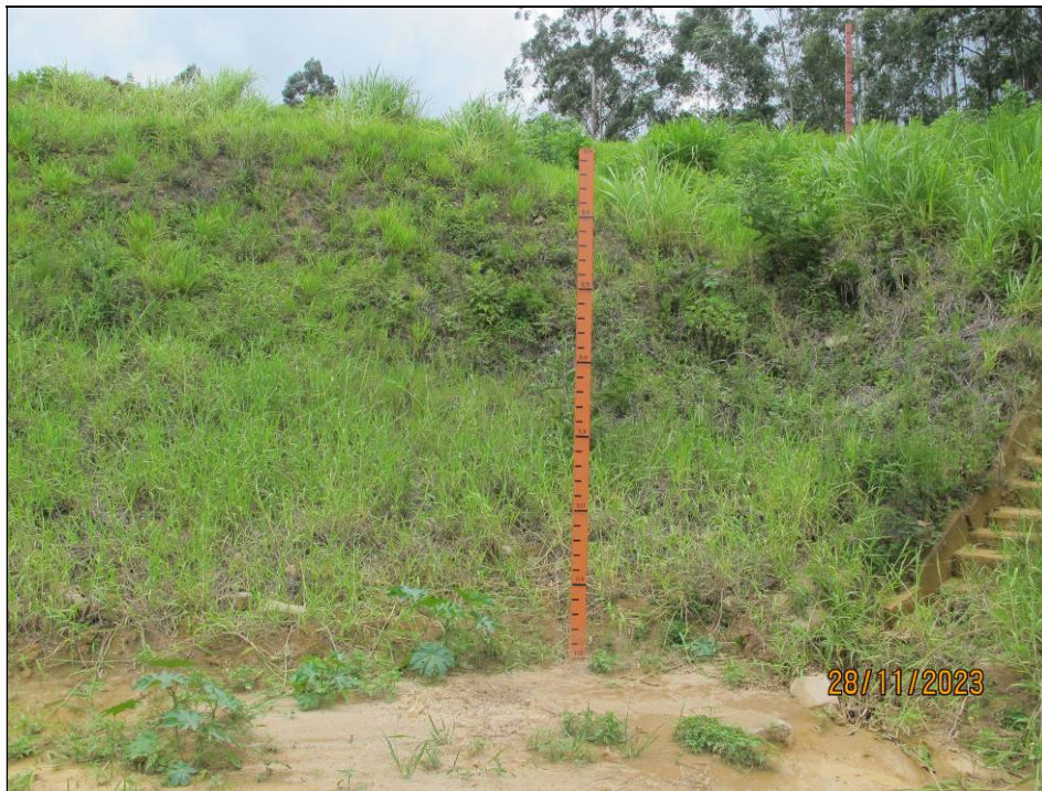
Figura 3.5- Régua linimétrica para medição dos níveis de assoreamento e da lâmina d'água.
