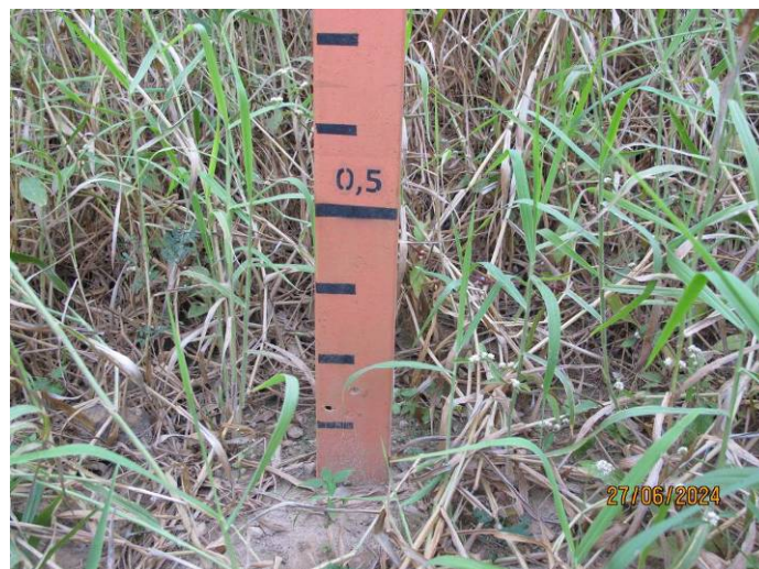
39- Registro de 27/06/24 – Detalhe da leitura do nível de assoreamento na régua de medição - Percentual de assoreamento: 1,25%.
