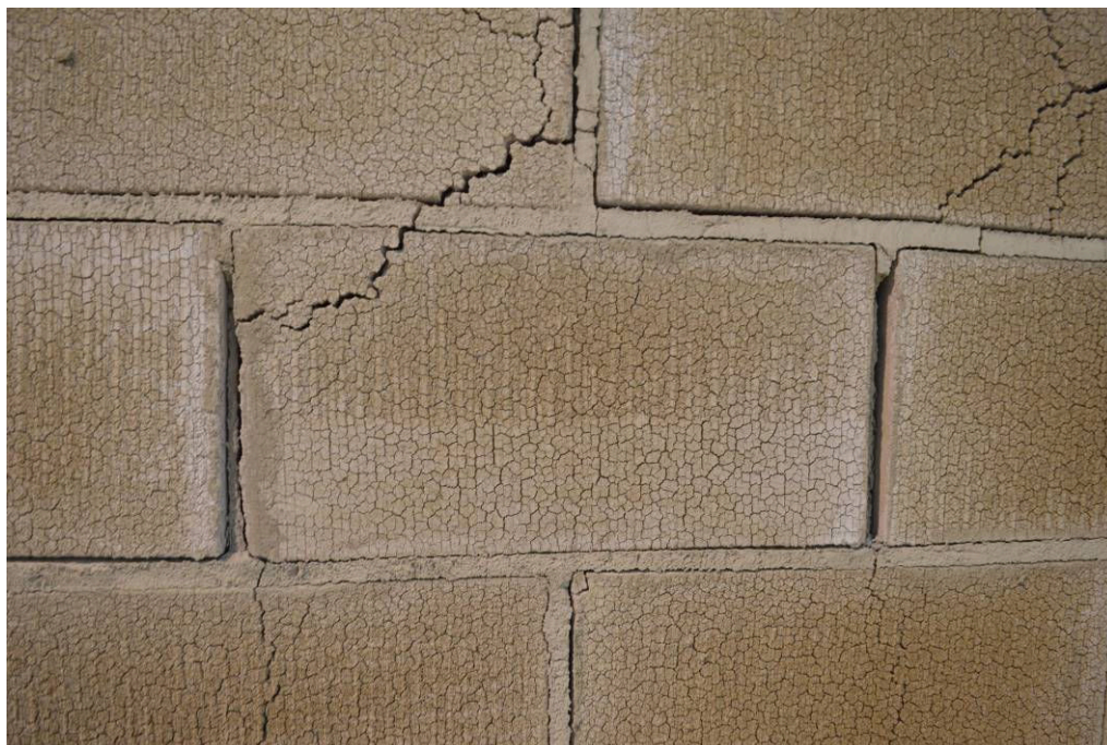
Fotografia 10 – Detalhes dos blocos e juntas após a realização do ensaio (face exposta ao fogo).
