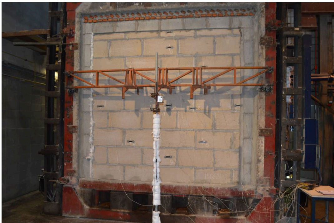
Fotografia 6 – Face não exposta ao fogo do corpo de prova e instrumentação.
