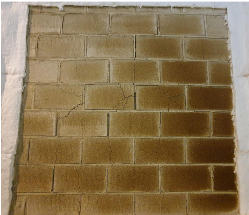
Fotografia 9 – Face exposta ao fogo do corpo de prova após a realização do ensaio
