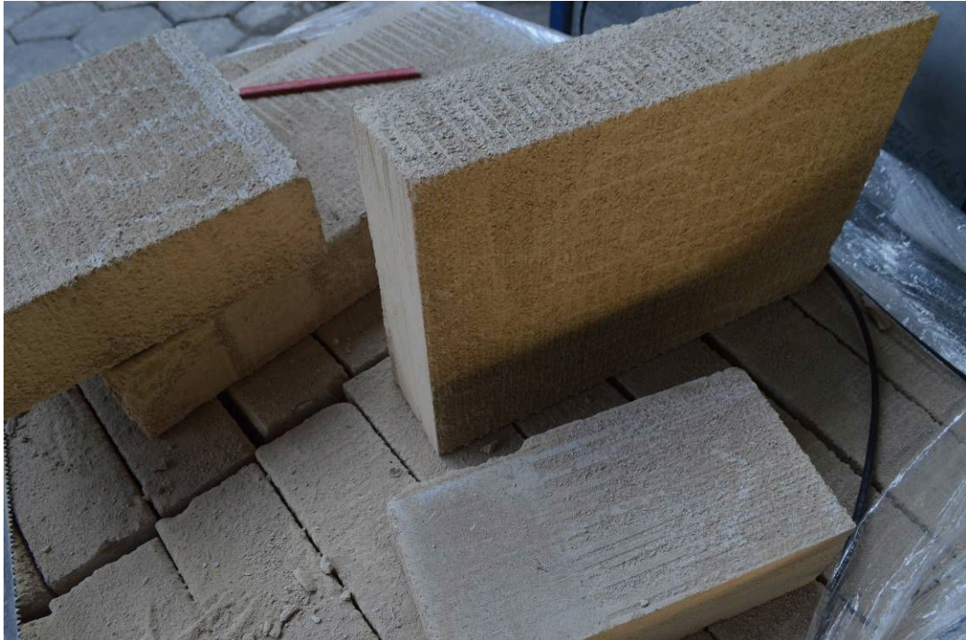
Fotografia 1 – Blocos utilizados na execução do corpo de prova (parede).
