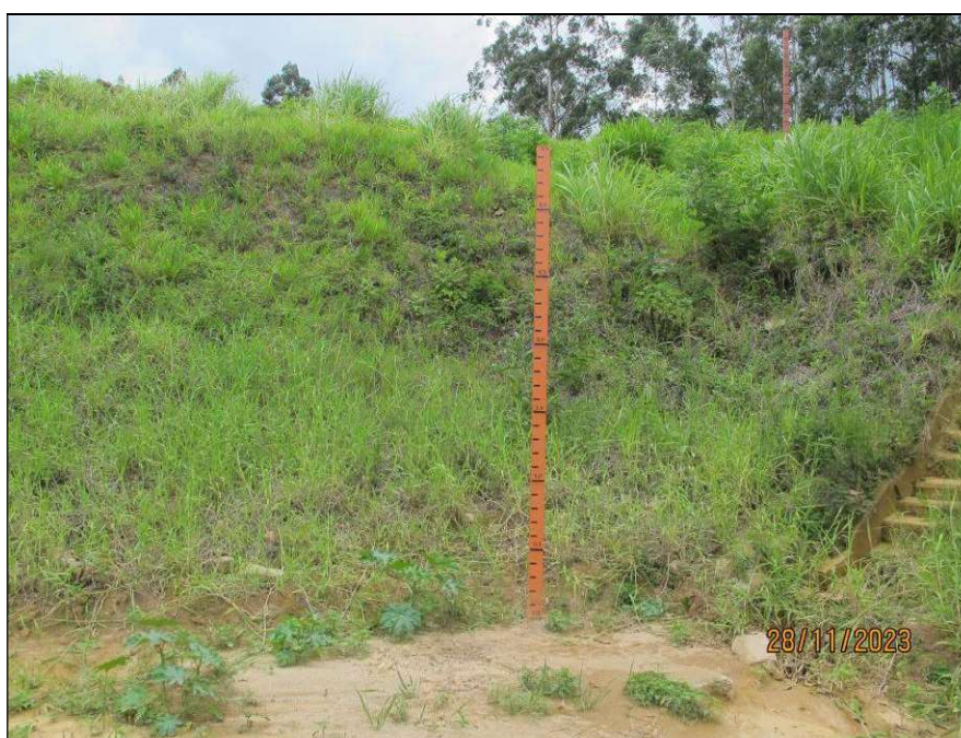
Figura 4.5- Régua linimétrica N° 2- Medição dos níveis de assoreamento e da altura da lâmina d'água.
